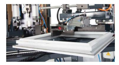
Single Line 1 Línea de Soldadura de 4 Cabezales y Limpiadora de Esquinas CNC
